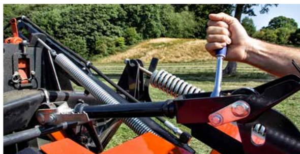
Le réglage de la hauteur de fauche est intégré directement dans le relevage de la machine. Il n'est pas nécessaire d'incliner la tête d'attelage.
