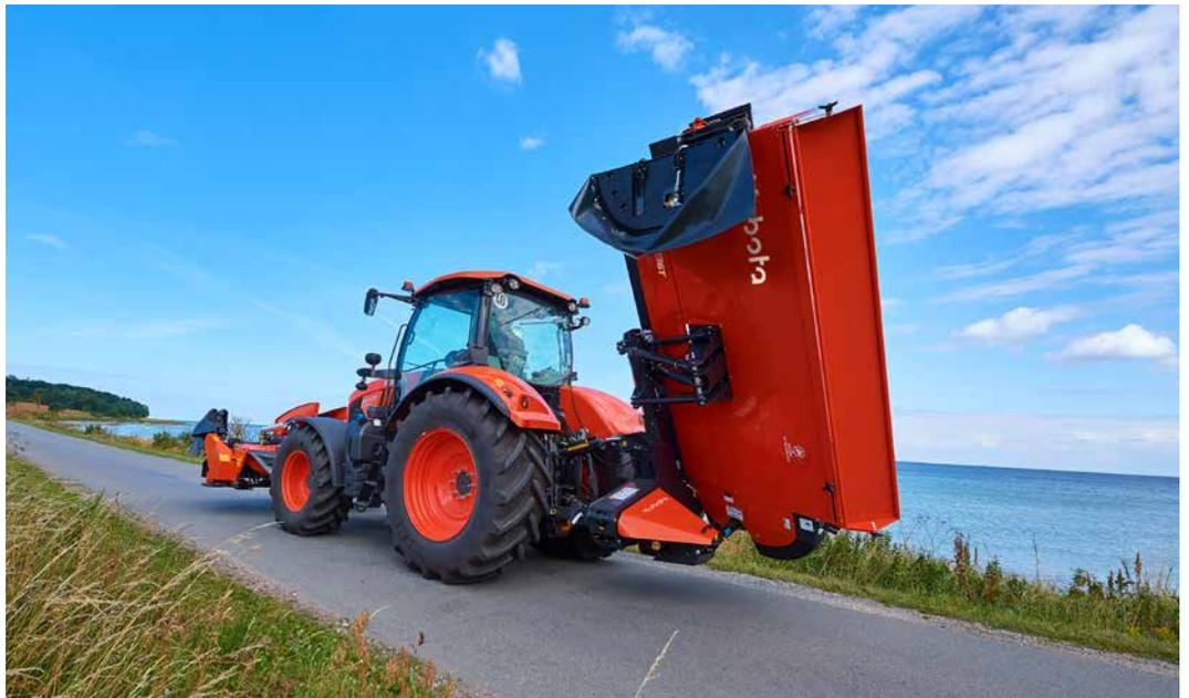
DMC6336T Vario au transport. Le bras télescopique du châssis se déplace dans la position la plus basse possible pour atteindre une hauteur de transport de seulement 3,70 m.
