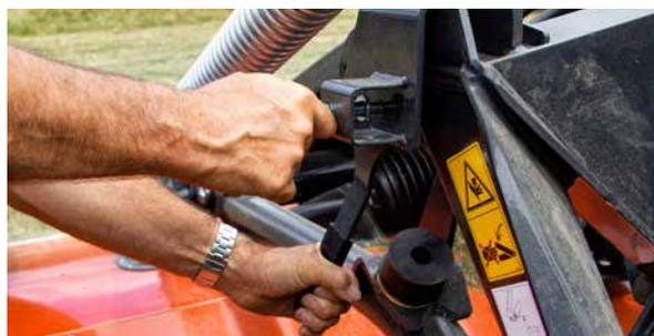
Une seule poignée de stationnement pour verrouiller et préparer la machine au démontage.
