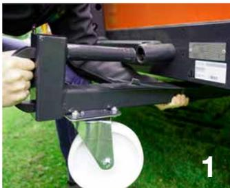
Faites coulisser les roulettes de transport spécialement conçues sur le tapis BX et retirez l'axe de fixation.
