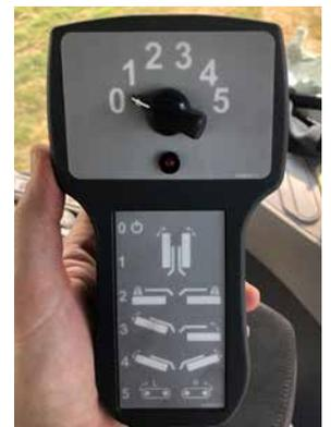
Les DMC 6387 et 6395 sont faciles à manipuler et fonctionnent en standard avec un boîtier de présélection PilotBox pour la montée/descente (individuelle) des unités de coupe et des tapis et le réglage de la pression au sol.
