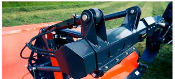
La position de l'unité de fauche peut être réglée en continu dans une fourchette de 150 mm sur le bras porteur, ce qui permet d'adapter la position de la faucheuse arrière à la largeur de travail de la faucheuse frontale ou aux roues arrière du tracteur.
