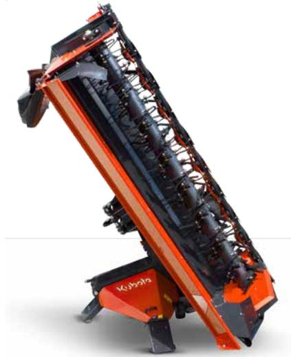
Lors du stockage vertical, les bras de relevage sont toujours en position horizontale, ce qui facilite le montage et le démontage de la faucheuse du tracteur.
