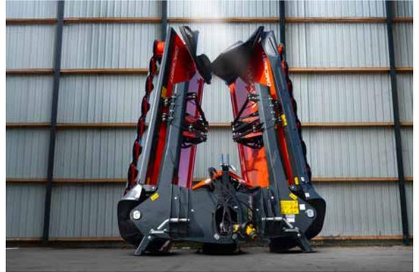
Grâce au dispositif de stationnement intégré, le stockage est facile et pratique, nécessitant un minimum d'espace pendant l'hivernage. La faucheuse est solidement remise sur des pieds de stationnement robustes et stables, ce qui ramène la hauteur totale à moins de 4,00 m.
