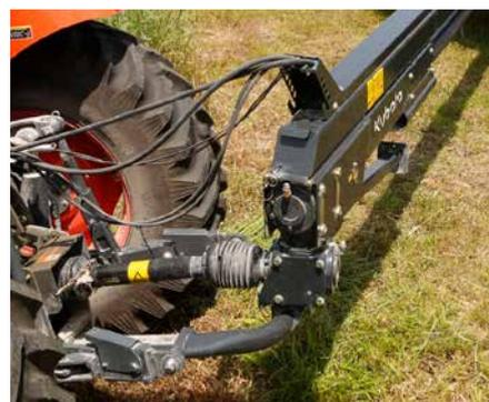
La tête pivotante offre un confort optimal lors des manœuvres en fourrière.
