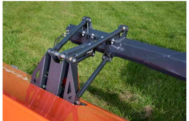
La position des unités de fauche peut être réglée en continu dans une fourchette de 150 mm sur le bras porteur pour s'adapter à la largeur de travail de la faucheuse frontale.
