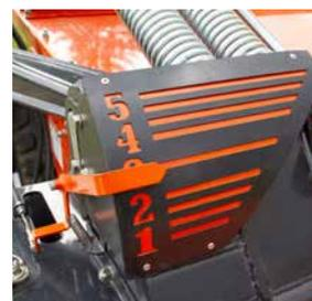
Réglage hydraulique de la hauteur de travail en option pour un réglage facile depuis la cabine du tracteur.
