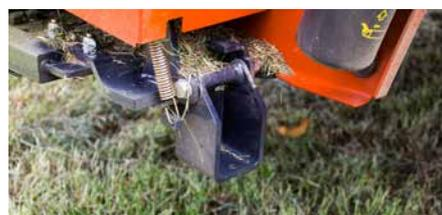
La béquille de stationnement est facilement activée et maintient parfaitement la faucheuse.
