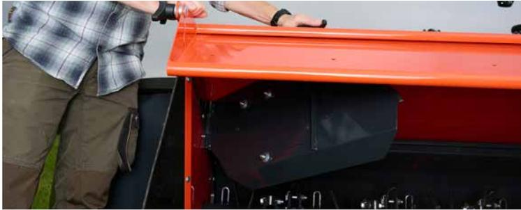
Les plaques d'andainage se déplient automatiquement lorsqu'elles sont glissées vers l'intérieur pour permettre un andainage efficace et précis.
