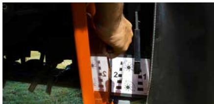
Double réglage de la tôle de conditionnement.
