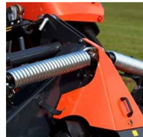
Ressorts de suspension de large section, réglables hydrauliquement, en option.
