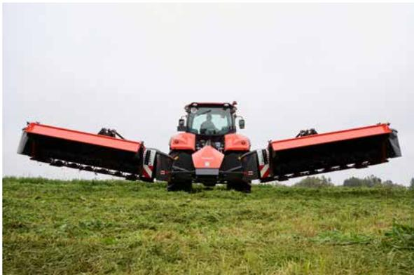
Dégagement au sol minimum de 500 mm sur l'ensemble de l'unité de fauche lors des manoeuvres en bout de champ. L'unité de fauche est relevée et le bras porteur est incliné à un angle de 10°.
