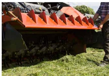
Le passage de l'andainage à l'épandage se fait pratiquement en une minute. Les tôles d'andainage sont facilement coulissées sur le côté et les vannes d'épandage FlipOver sont tournées à 180°. Aucun outil n'est nécessaire.
