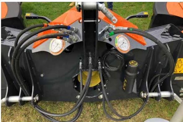
Toutes les fonctions hydrauliques sont contrôlées par les distributeurs du tracteur en combinaison avec un boîtier de présélection PilotBox.
