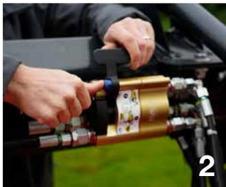
Débranchez le câble d'alimentation et les flexibles hydrauliques du tapis BX avec un seul levier.
