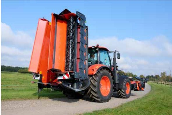
Les 2 modèles se replient dans une position de transport sûre, au-dessus de 90° pour une répartition stable du poids pendant le transport. Les protections extérieures se replient hydrauliquement en position de transport (en option), sans qu'il soit nécessaire de quitter la cabine du tracteur.
