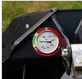
La pression au sol se règle facilement depuis le siège du tracteur, hydrauliquement, avec une indication de pression facile à lire sur la faucheuse pour un guidage clair.
