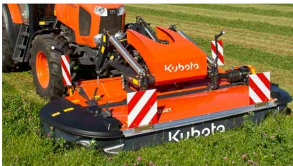
Ressorts de suspension placés à l'avant pour une plus grande stabilité et une pression au sol constante.
