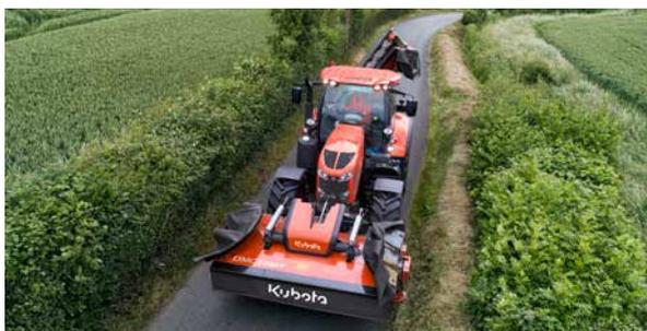
Repliage hydraulique des protections FlexProtect (en option).
